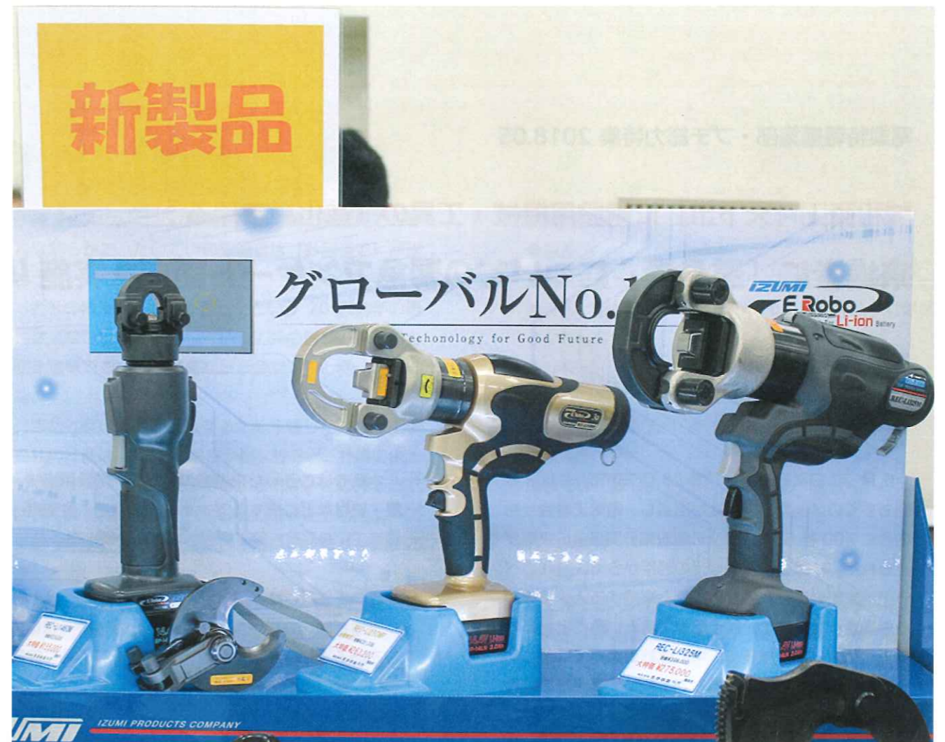
圧着・圧縮も1台でこなせる充電油圧式多機能工具(泉精機)
